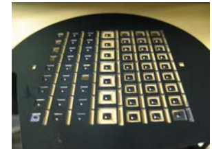
容量型3軸加速度センサの試作例
